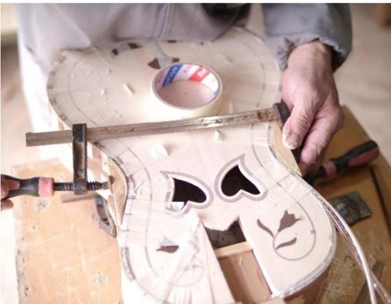
**Figura 35** - Reforço da colagem dos frisos laterais.
