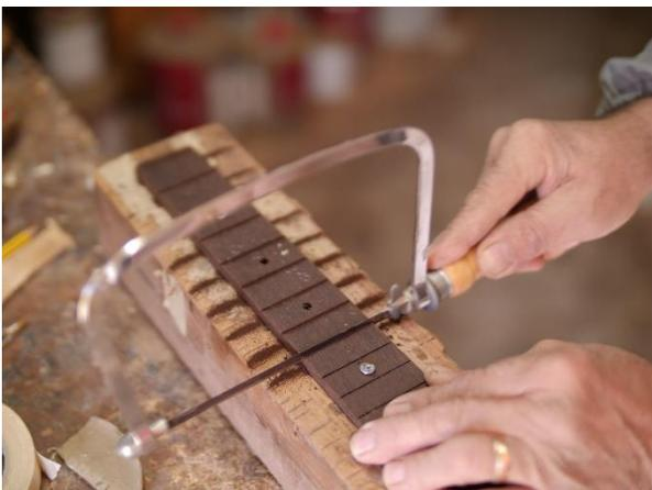
**Figura 21** - Preparação da escala.
