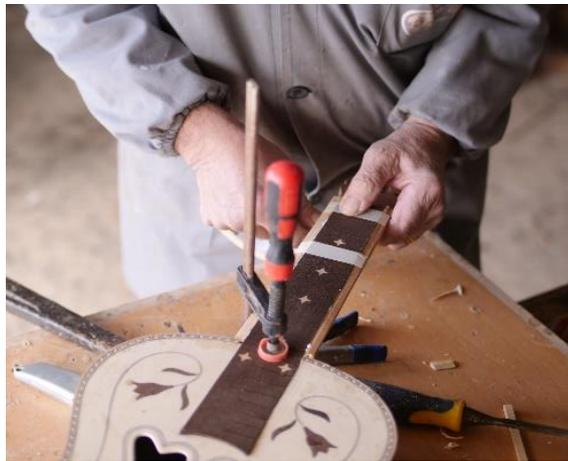
**Figura 33** - Colocação provisória da escala.
