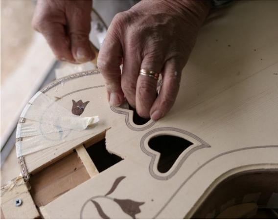
**Figura 31** - Colagem dos frisos laterais.
