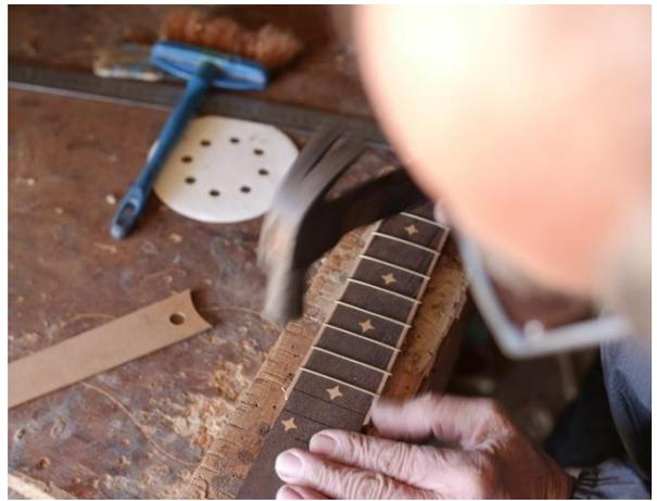
**Figura 34** - Aplicação dos trastos na escala.
