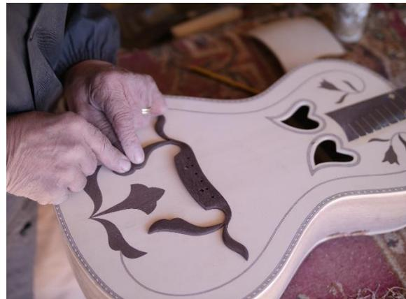
**Figura 40** - Colocação do cavalete provisório e dos bigodes.
