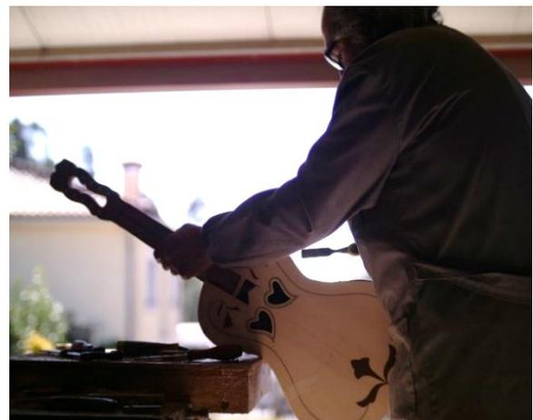
**Figura 30** - Preparação para a colagem dos frisos laterais.
