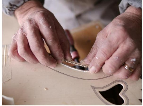
**Figura 32** - Colagem dos frisos laterais.
