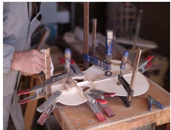
**Figura 18** - Colagem das travessas e contrafortes no interior do tampo.
