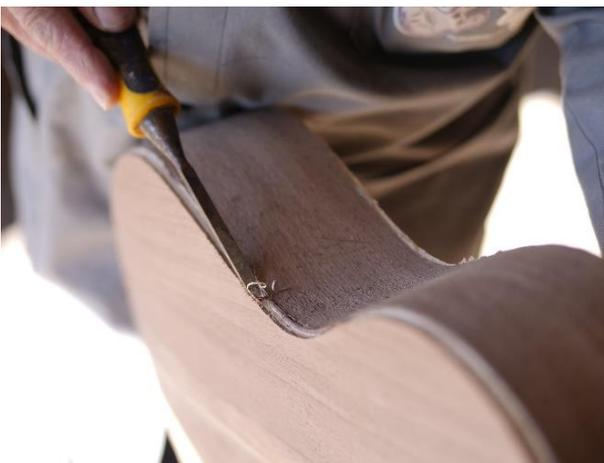
**Figura 29** - Preparação para a colagem dos frisos laterais.
