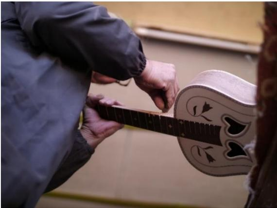
**Figura 39** - Remoção de excessos de madeira.
